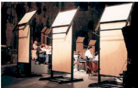
Κατασκευή και τοποθέτηση ηχοβελτιωτικών ανακλαστήρων στο Ηρώδειο
